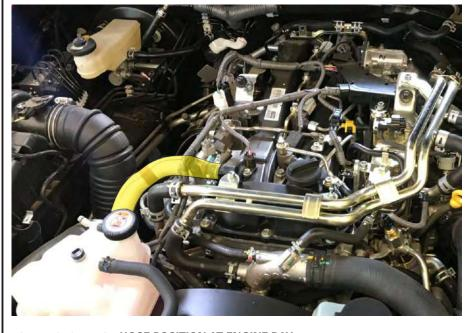
FIG. 3 FACTORY PCV HOSE POSITION AT ENGINE BAY
