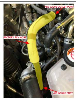
FIG. 4 FACTORY PCV HOSE IDENTIFICATION
